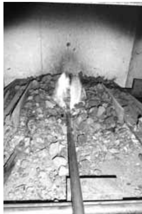
Le sandwich, soudé au bout du trainard pour pouvoir le manipuler, est en chauffe. Photo rj
