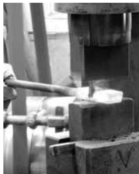
Après l'avoir travaillé sur l'enclume et au marteau-pilon, on coupe le sandwich en deux, réunit les deux portions et recommence le procédé. Photo rj
