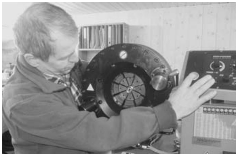
Opération de sertissage d'une douille de tuyau hydraulique. Les tuyaux subissent des pressions qui varient entre 250 et 450 bars. Photo jlm
