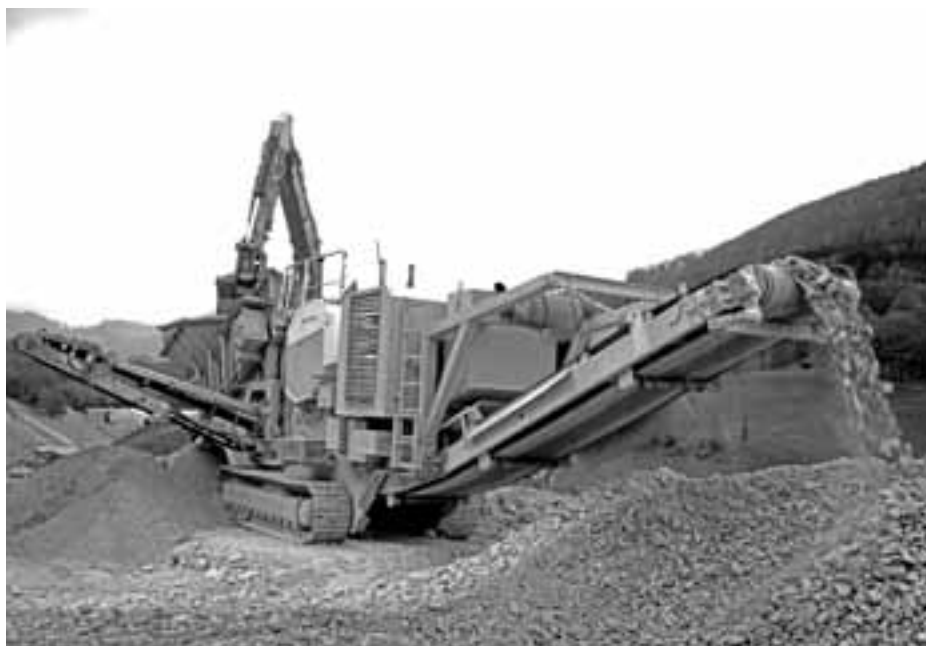
Derrière la machine qui concasse et trie, une pelle rétro à chenilles l'alimente de tout venant. Deux tapis rejettent le rebut (à gauche) et les graviers de différentes tailles (à droite). Photo jlm
