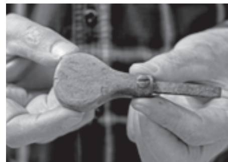
Quel est cet objet mystérieux? Un tournevis de réglage de la visée du fusil d'ordonnance Vetterli. Une rareté. Photo jlm
