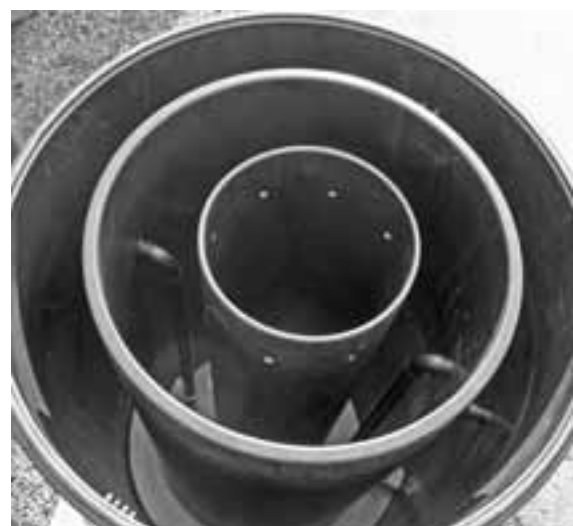
Le filtre à eau, détail des compartiments à graviers et sables filtrants. Photo lm
