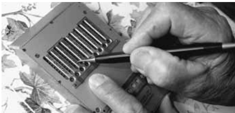
Maniement d'une calculatrice mécanique Stima (1932) à l'aide d'un stylo. Photo jlm
