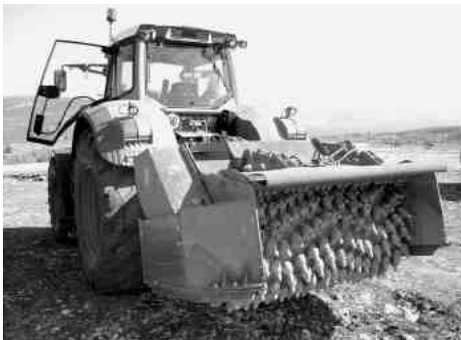
La fraise à roche dure, elle, a des dents régulières. Photo Gütty SA
