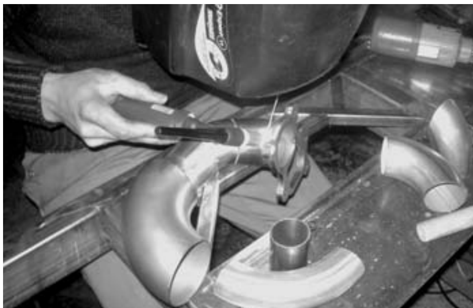
Soudage d'une tubulure. Photo rj
