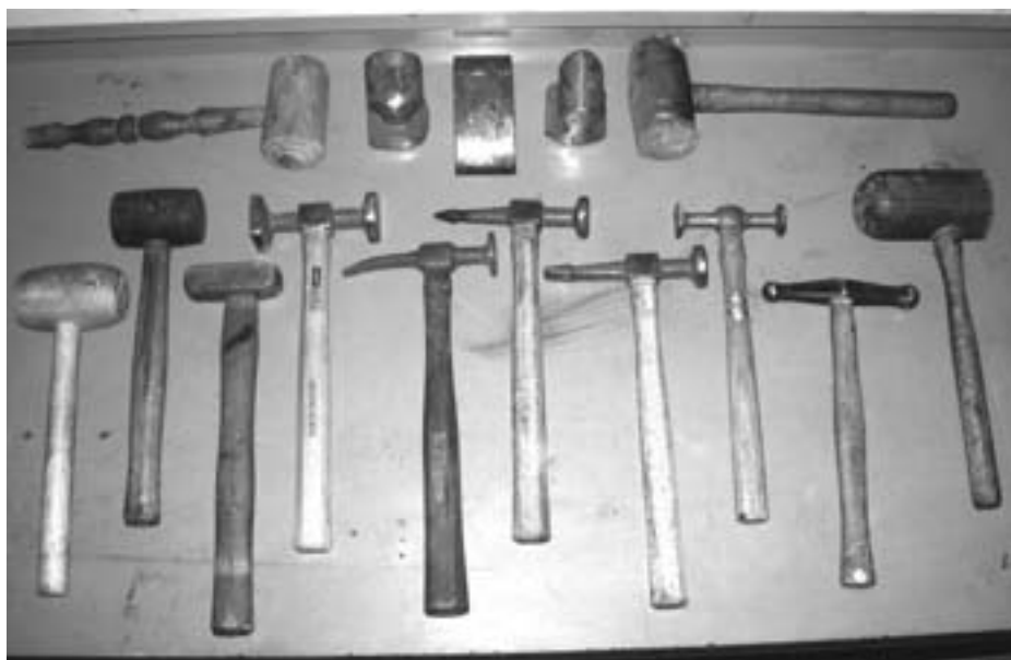
Quelques outils spécifiques pour le martelage des tubulures. Photo rj
