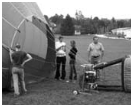
Opération de remplissage du ballon à l'air au moyen d'un ventilateur, ensuite le remplissage à l'air chaud à l'aide du brûleur, ce qui relève la nacelle en position verticale.
